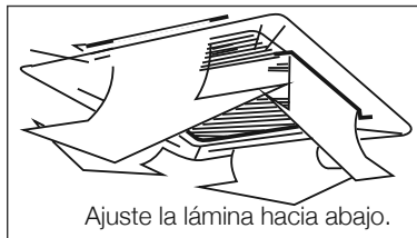
Figura 15 Funcionamiento de la calefacción
