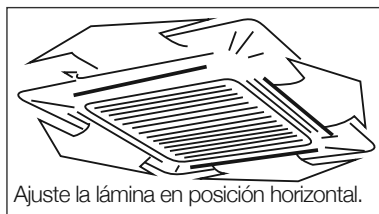
Figura 14 Funcionamiento de la refrigeración
